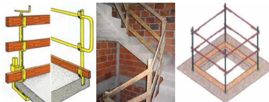
Figura 7.4 - Emprego de guarda-corpo em vãos internos de elevador, fossos, escadas, e bordas de lajes
